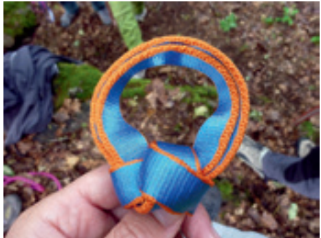
Gelegter Bulin-Knoten in Bandmaterial
